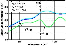
FIGURE 15. HARMONIC DISTORTION vs FREQUENCY
