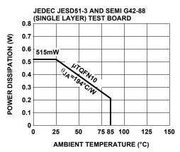
FIGURE 21. PACKAGE POWER DISSIPATION VS AMBIENT TEMPERATURE
