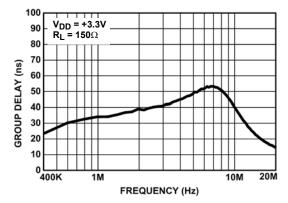
FIGURE 17. GROUP DELAY vs FREQUENCY
