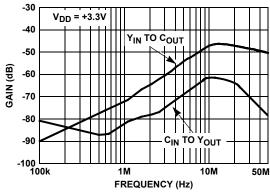
FIGURE 8. ISOLATION vs FREQUENCY
