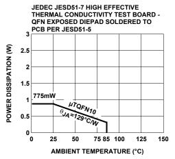
FIGURE 22. PACKAGE POWER DISSIPATION VS AMBIENT TEMPERATURE
