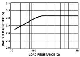
FIGURE 9. MAXIMUM OUTPUT vs LOAD RESISTANCE
